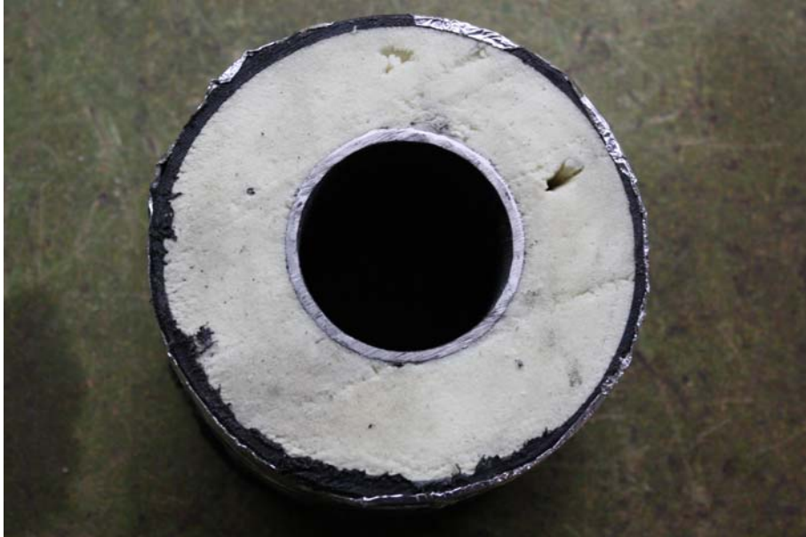
Bild 5: Untersuchung auf Lunker und Blasen, Querschnitt Nummer 1
