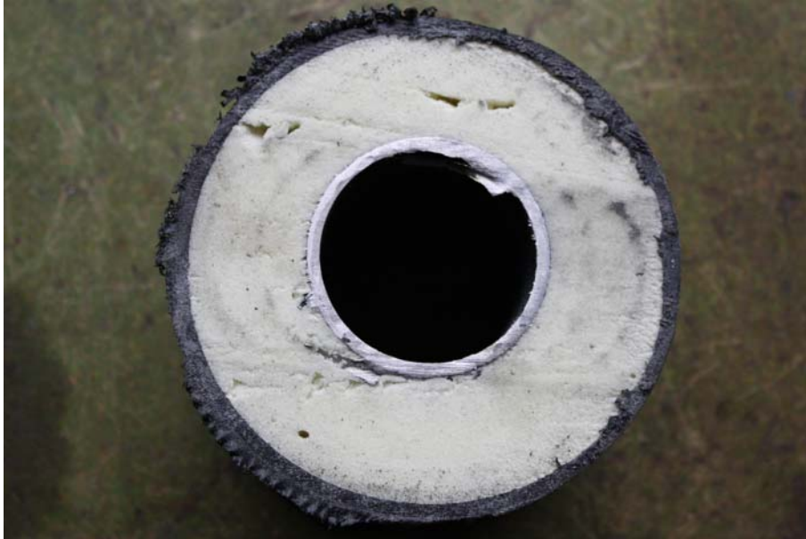
Bild 7: Untersuchung auf Lunker und Blasen, Querschnitt Nummer 3
