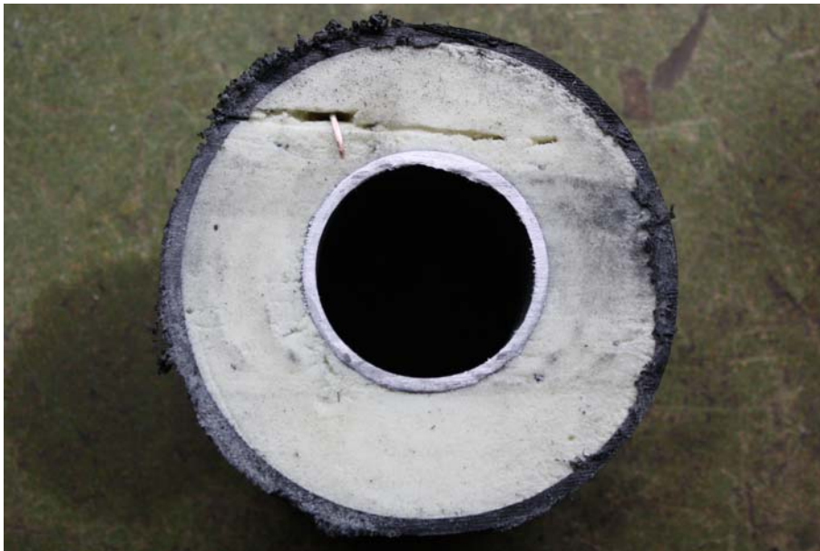
Bild 8: Untersuchung auf Lunker und Blasen, Querschnitt Nummer 4
