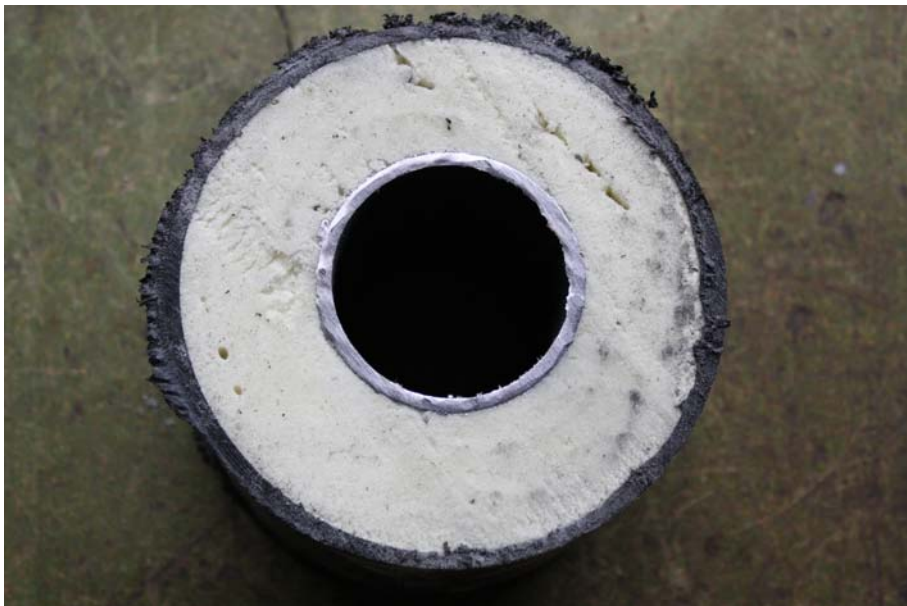
Bild 6: Untersuchung auf Lunker und Blasen, Querschnitt Nummer 2
