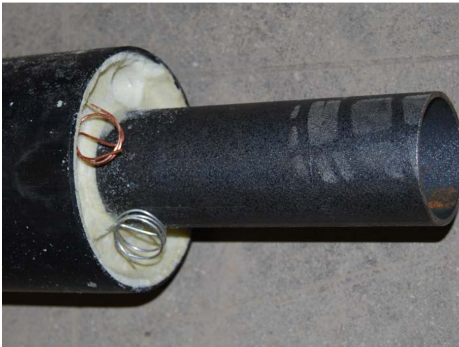
Bild 4: Rohrende mit gesandstrahltem Mediumrohr, Prüfling 2688
